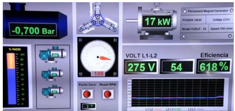
Messung vom 20. April 2016 an einer 17-kW-Anlage. Es errechnete sich ein COP von 6,18:1.
