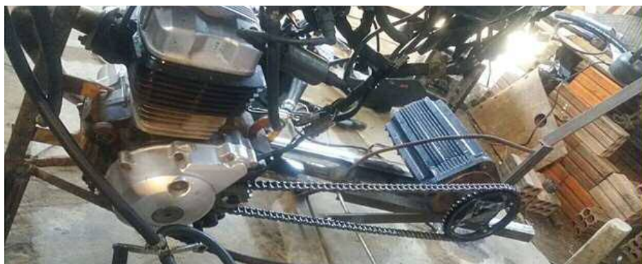
Der von José Vaesken Guillen am 8. Juni 2019 ausgebauten und mit einem elektrischen Generator gekoppelte Motor einer Honda Flex 150 ccm.
