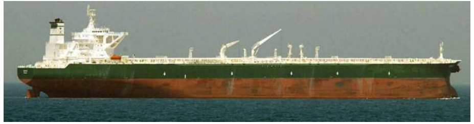
Foto eines Öltankers (Very Large Crude Carrier VLCC) der gleichen Grösse wie das projektierte Spezialschiff zur Plastikmüllentsorgung. Abmessungen: Länge 350 m, Breite: 60 m, DWT (Dead weight tons), Tragfähigkeit solcher Schiffe: 350'000 t.
